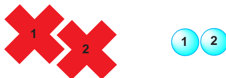
FIG. 2.29 – Les interactions moléculaires en phases condensées dépendent de la taille et de la géométrie des molécules ; les grandes croix interagissent plus entre elles que les petites sphères et leur séparation (passage de la phase liquide à la phase gazeuse lors de l'ébullition par exemple) réclame donc plus d'énergie.
