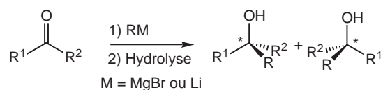
FIG. 7.10 – Bilan de la réaction d'addition des organo-métalliques sur les dérivés carbonyles.
