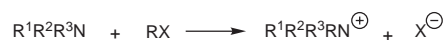
FIG. 5.70 – Obtention d’un sel d’ammonium par réaction d’une amine tertiaire avec un dérivé halogéné.
