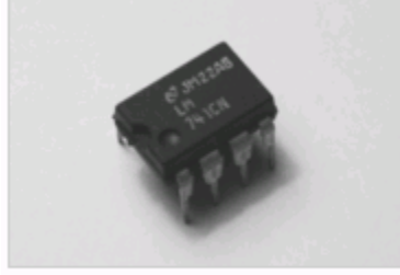
Amplificateur opérationnel LM741 en boîtier DIP8
